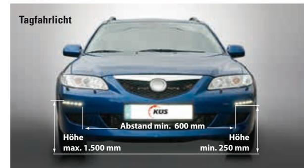
Bei der Verwendung als Positionslicht muss die Mindestbauhöhe 350 mm betragen und der von der Fahrzeugmitte am weitesten entfernte Punkt der Leuchtfläche darf nicht mehr als 400 mm vom äußersten Punkt der Gesamtbreite des Fahrzeuges entfernt sein.
