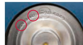
**Nachrüstleuchte** mit adaptivem Tagfahrlicht in kombinierter Form mit der Positionsleuchte (Standlicht). Die Leuchte trägt dann **zusätzlich** noch die Kennung „A“ (für Positions- bzw. Begrenzungslicht).
