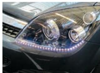
Beispiel einer unzulässigen Veränderung des Hauptscheinwerfers durch Einbringung von LED-Streifen.
